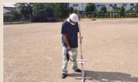
①空間放射線量の計測 国の除染基準値以上のエリアを特定します
